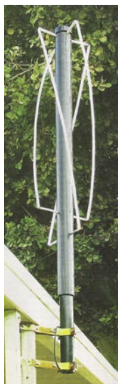
Antena Qadrifilar QHF składa się z dwóch pętli, o różnej długości, skręconych o 90^\circ . Antena ma polaryzację poziomą [11]
