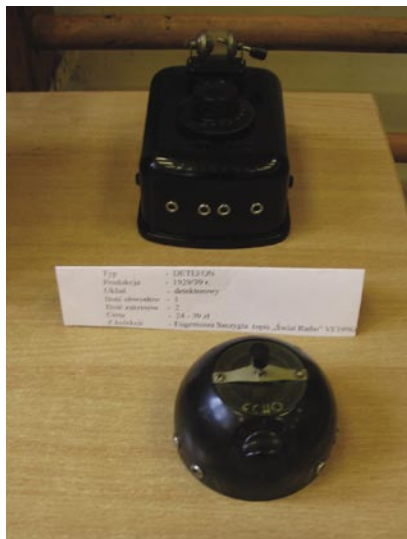
Odbiornik detektorowy Detefon ze zbiorów Eugeniusza Szczygła (1929...1934 r.), poniżej odbiornik detektorowy Echo – D1 ze zbiorów Henryka Berezowskiego (1935 r.)
