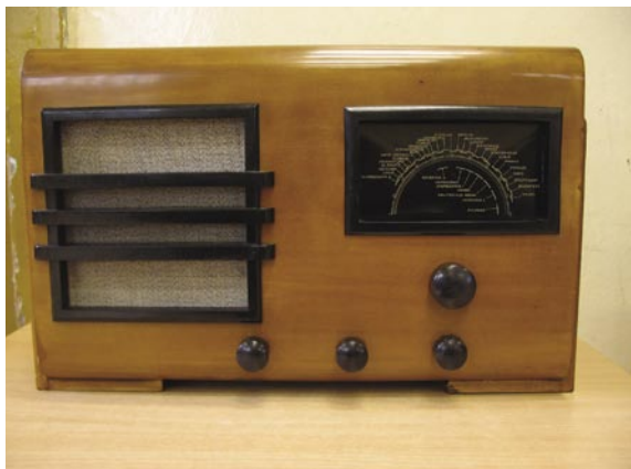
Odbiornik Echo-127 (reakcyjny, 1-obwodowy, 2-zakresowy, skala stacyjna, skrzynka z szarego jawora)
