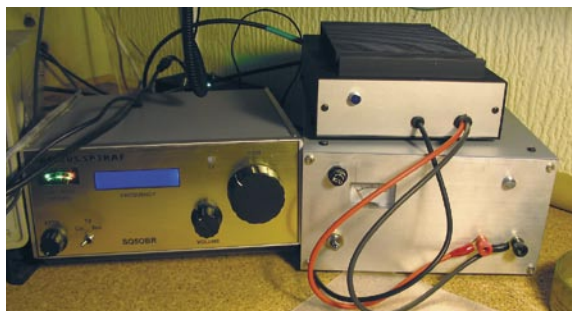
Fot. 1. Wzmacniacz Tajfun (po prawej stronie na zasilaczu; po lewej stronie TRX/80m Proteus) wykonany przez SQ50BR
