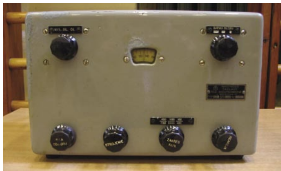
Odbiornik reakcyjny OB2 ze zbiorów Edwarda Szymczaka (zakres: 162–3000 kHz; lampy: 2 × KF4, KC3, KDD1)
