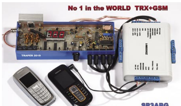
Piotr SP3ABG skonstruował chyba pierwszy na świecie transceiver amatorski sterowany telefonem komórkowym. Jak widać na zdjęciu, przekonstruowany transceiver Traper współpracuje ze specjalnie wykonanym zewnętrznym sterownikiem ZSGSM1
