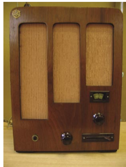
Odbiornik Echo-124 (reakcyjny, 1-obwodowy, 2-zakresowy, skala stacyjna, głośnik magnetyczny; lampy: E424N, B443, 1802)
