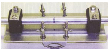
Mocowanie elementów reflektora na płycie montowanej na nośniku
