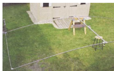
Widok połowy anteny na stanowisku montażowym
