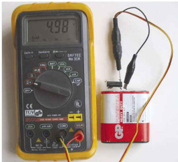
Fot. 1. Pomiar napięcia Upp na wyjściu oscylatora kwarcowego 3,5795 MHz zasilanego z baterii płaskiej 4,5 V (sonda przed kalibracją)
