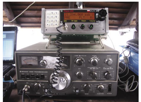
Dwie technologie transceiverów demonstrowane podczas ogniska na Bemowie 2010 (od dołu): lampowy Kenwood TS520, Pilgrim SMD w wykonaniu Wacka SP5JPB
