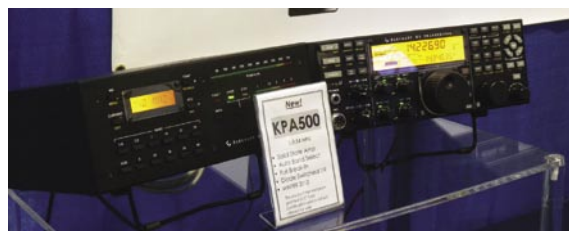
Transceiver K3 + KPA500 (wzmacniacz o wymiarach K3, 500 W out, 12 kg wagi, cena ok. 2000 USD; będzie w sprzedaży pod koniec roku 2010)
