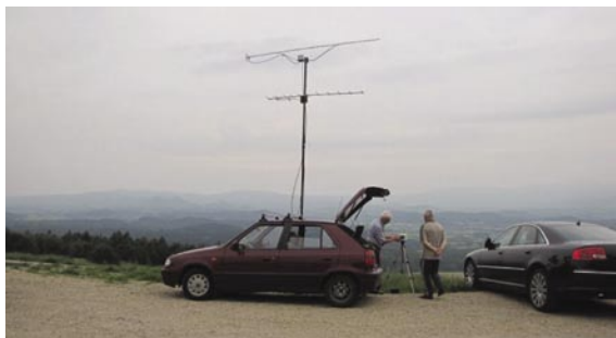
SP6LB uruchamia TRX 10 GHz. Na samochodzie zamocowane są anteny 70 cm i 23 cm na wspólnym maszcie
