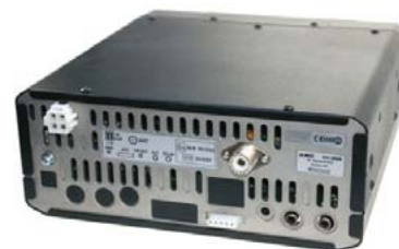
Tylna ścianka DX-SR8E zawiera niewiele elementów: gniazda antenowe i zasilania oraz gniazda służące do podłączenia klucza telegraficznego, zewnętrznego obwodu dopasowującego antenę, wejście sygnału ALC i wyjście sterujące dla wzmacniacza mocy
