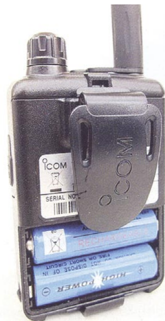
Fot. 2. W skład standardowych akcesoriów wchodzi akumulatorki, które można ładować bez ich wyjmowania z odbiornika. Może on też być zasilany z dwóch zwykłych baterii paluszkowych
