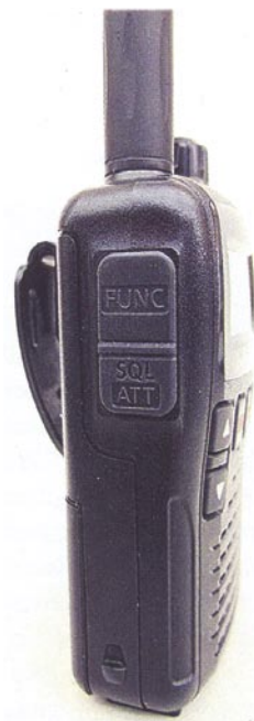
Fot. 3. Znajdujący się na lewej ścianie poniżej przycisku funkcyjnego przycisk podsluchu pozwala przy pracy duplexowej na odbiór częstotliwości wejściowych przemenników
