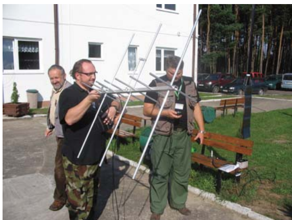
Tomek SQ7IQI testuje dwupasmową antenę 2 m/70 cm do pracy przez satelity LEO
