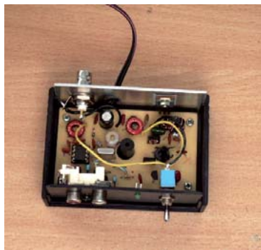
Minitransceiver SPK NIKI – SP7NJR po zdjęciu obudowy i zamontowana płytka drukowana
