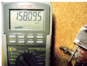
Skalowanie kalibratora przeprowadza się, ustawiając potencjometrem dostrojącym dokładnie 158 mV w punkcie testowym
