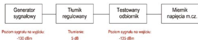
Rys. 1. Schemat układu do pomiaru MDS i czułości odbiornika
