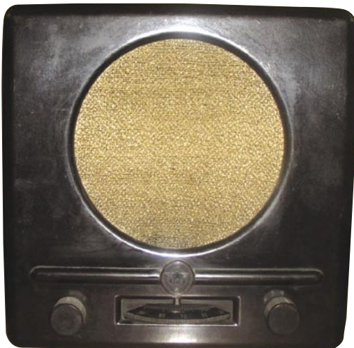
Odbiornik IKA DKE 38 ze zbiorów Macieja Białeckiego (1940/44, reakcyjny, 1-lampowy: VCL11 i VY2; 1 obwód, 2 zakresy, zasilanie uniwersalne (110 V, 150 V, 220 V), głośnik magnetyczny; wymiary: 24×24×12 cm; waga: 2,5 kg)
