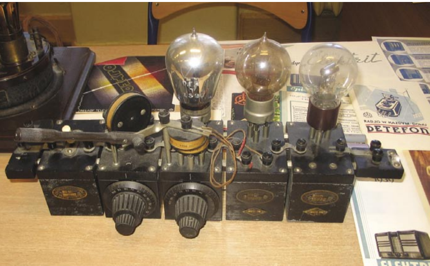
Odbiornik IKA typ 24Z ze zbiorów Piotra Irzmańskiego (1938/39, układ reakcyjny, 2 obwody, duorezektor; lampy: EF9, EF6, EL3, AZ1)
