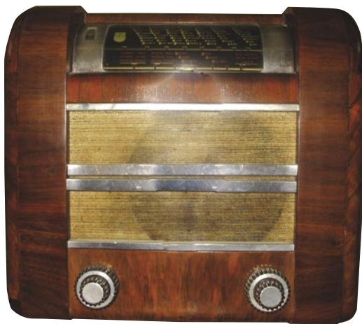
Odbiornik IKA typ 46Z ze zbiorów Henryka Berezowskiego (1937/38, superheterodyna refleksowa, 6 obwodów, regulacja barwy tonu, ARW, oko magiczne; wymiary: 46,5×35×23 cm, lampy: EK2, EBC3, EL3, EM1, AZ1)
