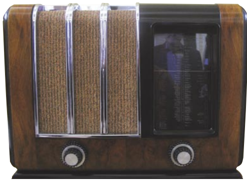
Odbiornik IKA typ 46Z ze zbiorów Henryka Berezowskiego (1937/38, superheterodyna refleksowa, 6 obwodów, regulacja barwy tonu, ARW, oko magiczne; wymiary: 46,5×35×23 cm, lampy: EK2, EBC3, EL3, EM1, AZ1)
