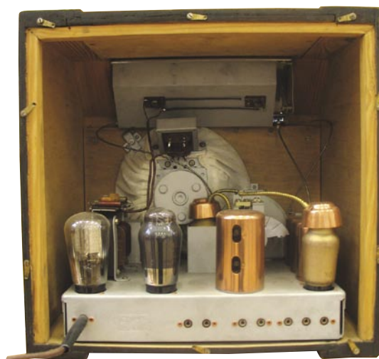
Odbiornik IKA typ 42Z ze zbiorów Henryka Berezowskiego (1937/38, układ reakcyjny, 2 obwody, duoreżektor; wymiary: 38×39×28 cm, lampy: AF3, AF7, AL4, AZ1)
