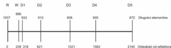
Rys. 4a. Antena G0KSC 7-el. 144 MHz szerokopasmowa z dobrymi stosunkami F/S i F/B. Nośnik 15 \times 15 , elementy \varnothing 12 mm. Przy \varnothing = 10 mm długość elementów \times 1,003
