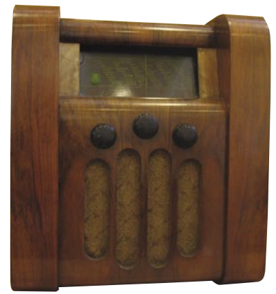
Odbiornik IKA typ MARS Z ze zbiorów Eugeniusza Szczygła (1936/37, reakcyjny, 2 obwody, 3 zakresy, eliminator podwójny, AF3, AF7, AL4, AZ1)
