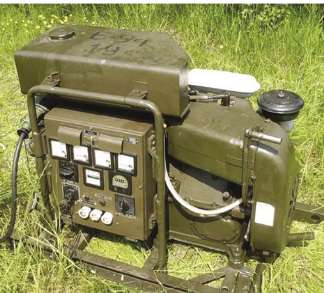
Zespół spalinowo-elektryczny PAB
