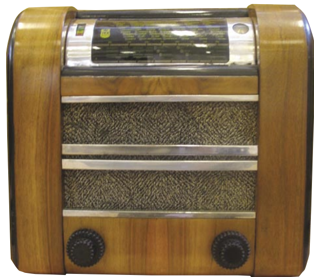
Odbiornik IKA typ 67Z ze zbiorów Eugeniusza Szczygła (1937/38, 7 obwodów, superheterodyna, wymiary: 38×41×28,5 cm, lampy: AK2, AF3, ABC1, AL4, AM1, AZ1)
