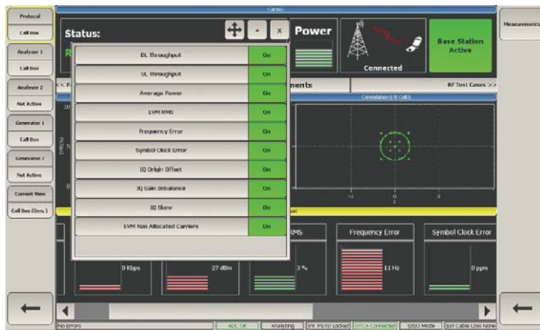
Rys. 3. Główne okno pomiarów RF w trybie Call Box
