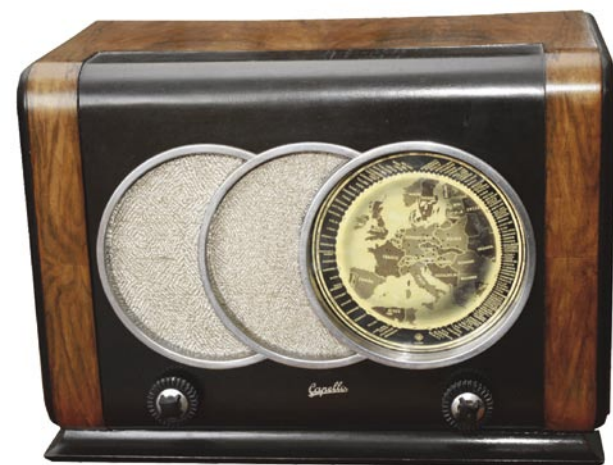
Capello Milano Z: 5 lamp (AK2, AF3, ABC1, AL4, AZ1), superheterodyna, 7 obwodów, 3 zakresy, ARW, regulacja barwy tonu i szerokości wstęgi, pasmo akustyczne 16 Hz-10,000 Hz, głośnik dynamiczny, skala geograficzna, pobór mocy 60 W
