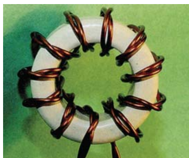
Rys. 12b. Balun 1 : 4, 2 x 10 zwojów, 1.0 CuL, bifilarnie
