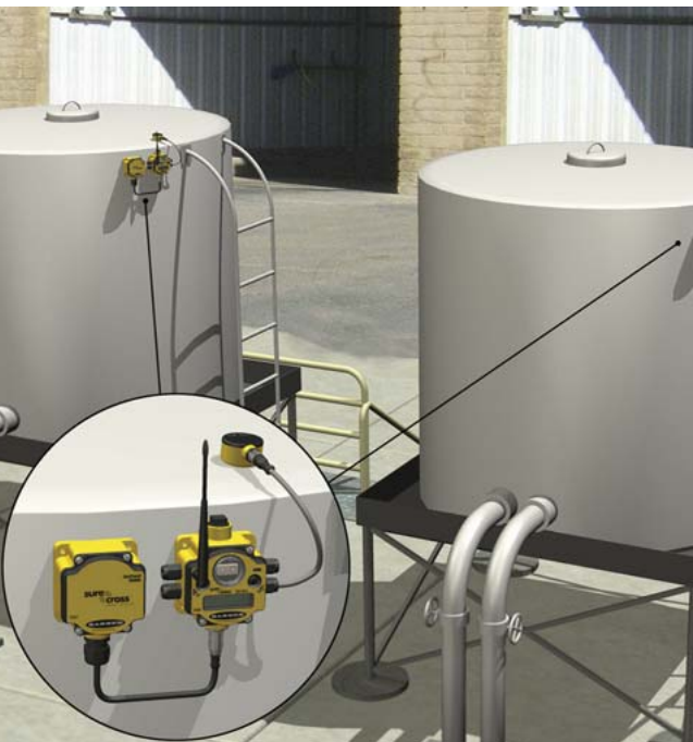
Dane z czujnika poziomu napełnienia w sposób ciągły są przekazywane za pomocą systemu komunikacji bezprzewodowej DX80 do systemu sterowania
