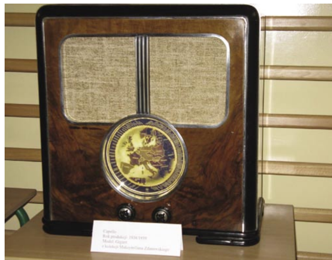
Capello Gigant Z: 5 lamp (EK2, EF9, EBC3, EL3, AZ1), superheterodyna, 7 obwodów, 3 zakresy fal 15–2000 m, ARW, regulacja barwy tonu i szerokości wstęgi, pasmo akustyczne 16 Hz–10 kHz, 2 głośniki dynamiczne, skala geograficzna, pobór mocy 50/35 W
