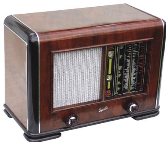
Capello Belcanto Z: 6 lamp (EK2, EF9, EBC3, EL3, EM1, AZ1), superheterodyna, 7 obwodów, 3 zakresy fal 15–2000 m, ARW, regulacja barwy tonu i szerokości wstęgi, pasmo akustyczne 16 Hz–10 kHz, głośnik dynamiczny z magnesem stałym, piękna i wielobarwna skala, pobór mocy 50/35 W
