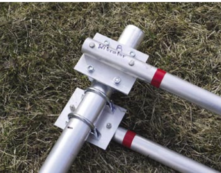
Mocowanie reflektora i wibratora
