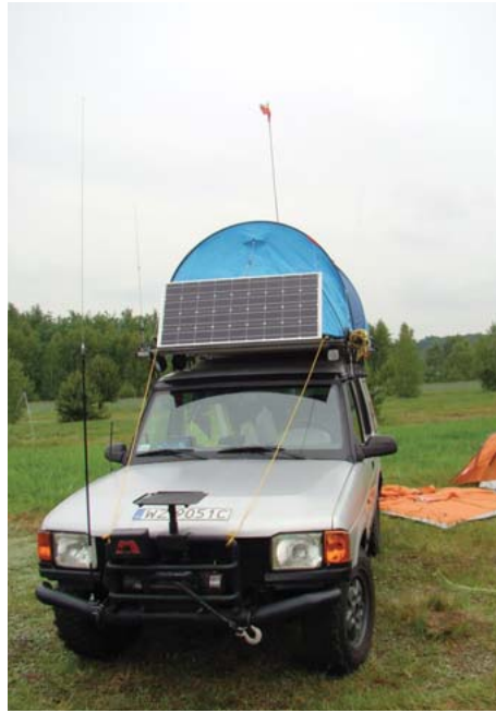
Zamontowany na samochodzie Andrzeja SP5RDK panel słoneczny 800 W dostarcza napięcia 17 V do zasilania nie tylko radiostacji
