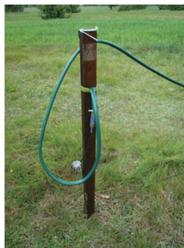
Pomiędzy symetrykiem a koncentrykiem znajduje się balun (7 zwojów kabla H155 na toroidzie F82 o średnicy 40 mm)
