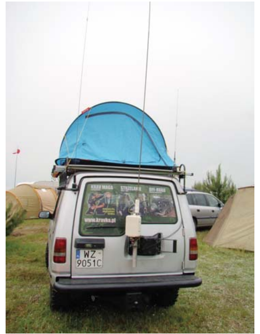
Zamontowany na samochodzie Andrzeja SP5RDK panel słoneczny 800 W dostarcza napięcia 17 V do zasilania nie tylko radiostacji
