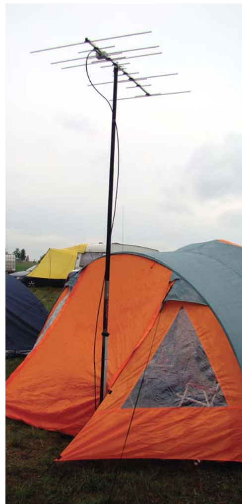
Jeden z uczestników spotkania ŁOŚ 2011 używał dwupasmowej Yagi DK7ZB 144/430 MHz 5+8 el. 150 cm
