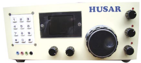
Prototypowy transceiver Husar konstrukcji Zdzisława SP4HKQ
