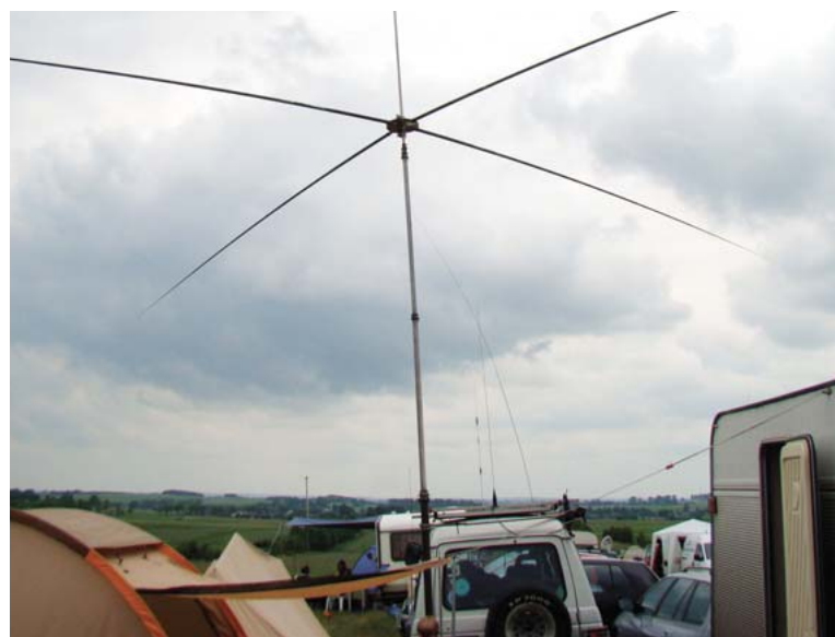
Antena typu Spider Beam Arka SQ6XL w trakcie budowy (widok z tyłu samochodu)
